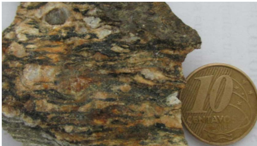
Figura 6-17: Na superfície de alteração fica mais nítida a textura milonítica. Fonte: do autor.
