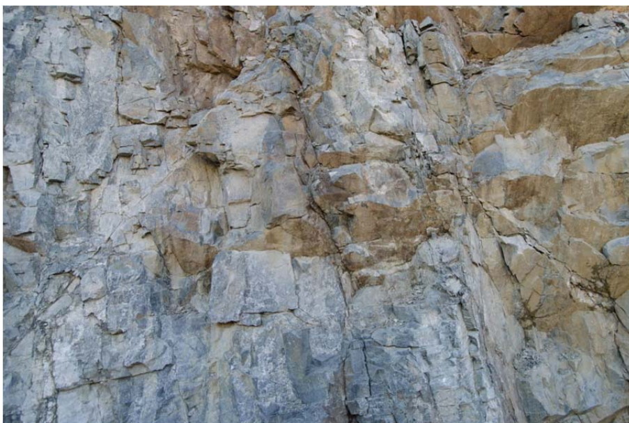
Figura 6-22: Gnaiss granulítico muito fraturado da pedreira. Fonte: do autor.
