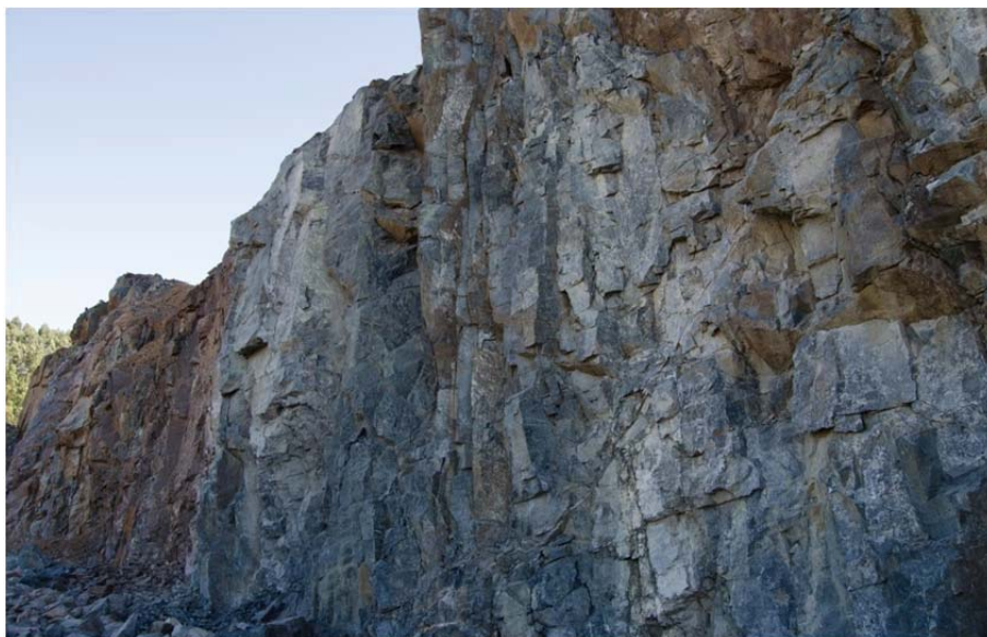
Figura 6-14: Parede de gnaiss na pedreira. À esquerda a rocha está oxidada. Fonte: do autor.
