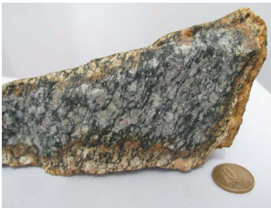
Figura 6-16: Amostra do gnaiss com bordas de alteração. Fonte: do autor.
